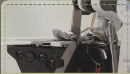
**Ober- und Untermesser:** Für sauberes und sicheres Schneiden an den Stoffkanten, sogar dicke Stoffe.
