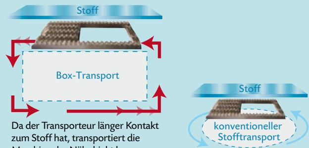
Da der Transporteur länger Kontakt zum Stoff hat, transportiert die Maschine das Nähobjekt besser.
