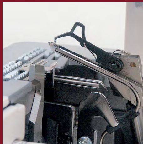
extrastarke Greifer mit schwenkbarem Hilfsgreifer
